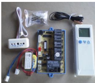
PLACA UNIV AA C/REM 3 VELOCIDADES U03C 2 SONDA
