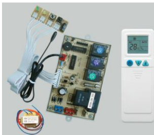
PLACA UNIV AA C/REM 2 VELOCIDADES U02 1 SONDA
